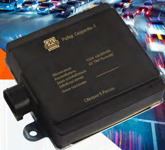
Радар Скорость-1, является радиолокационным измерителем скорости и предназначен для обнаружения движущихся транспортных средств, детектирования их скорости и направления движения. Радар состоит из модуля антенной решетки (АР) и модуля цифрового вычислителя, размещённых внутри радиопрозрачного корпуса. Модуль цифрового вычислителя разработан на основе 32-разрядного высокопроизводительного российского процессора цифровой обработки сигналов производства АО «ПКК Миландр».
